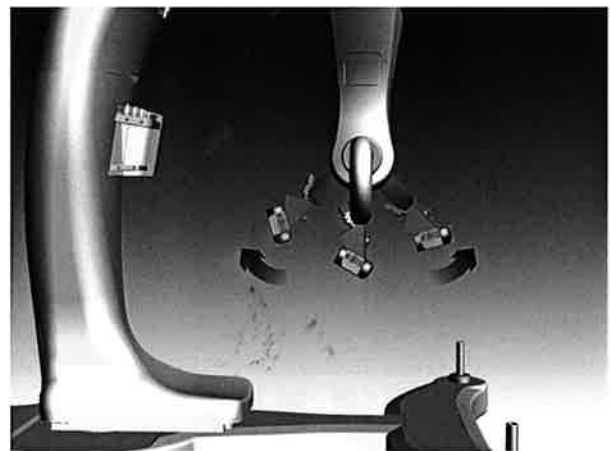
第3図(2) ガン角度を上下に振る
